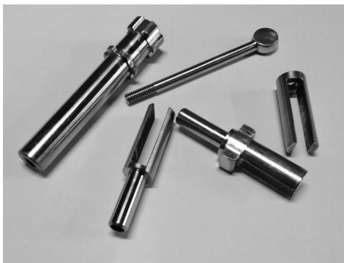
Рисунок 5.8 - Пальцы из стали 20Х13 двигателя внутреннего сгорания М-1 мощностью 4 кВт
