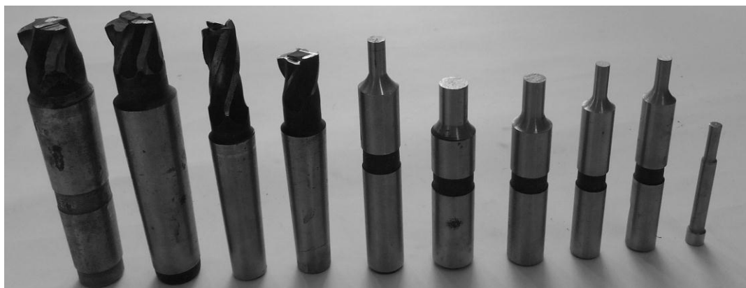
Рисунок 5.7 – Пуансоны для холодной пробивки отверстий из сталей X12Ф1 и X12МФ
